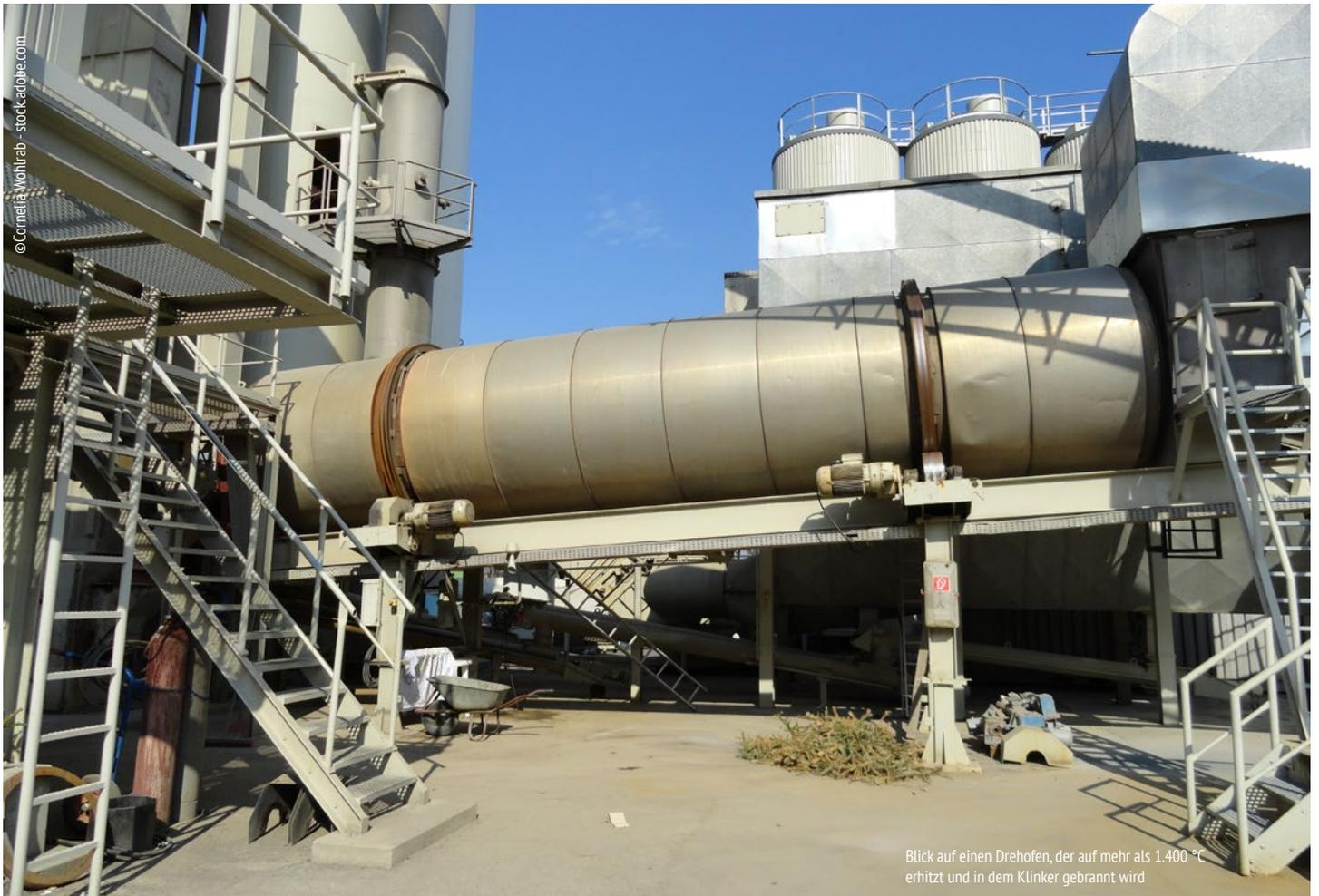
Blick auf einen Drehofen, der auf mehr als 1.400 °C erhitzt und in dem Klinker gebrannt wird
